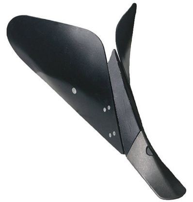
Mit dem Häufelkörper wird die Erde aus der Mitte wieder zu einem Damm aufgehäufelt
