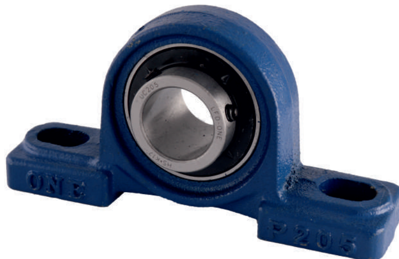
Stehlager mit gedichtetem Rillenkugellager. Der Festsitz der Welle wird mittels Madenschrauben gewährleistet.
