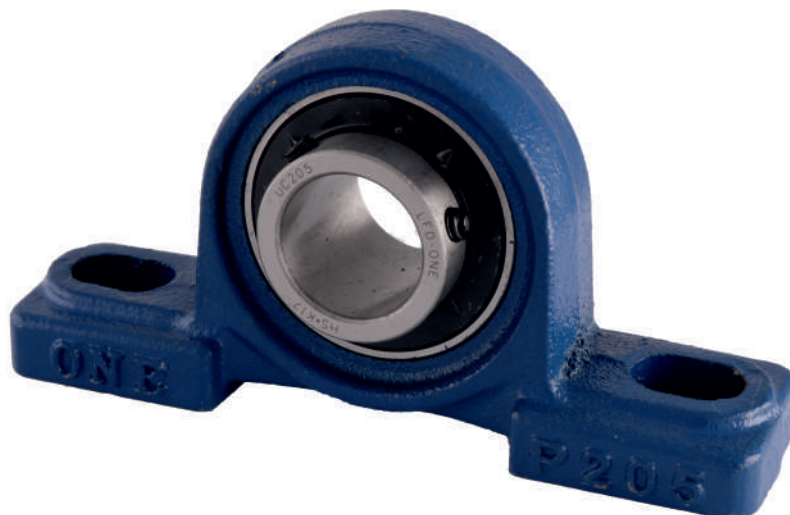
Ståleje med tætnet sporkugleleje. Akslens stramme pasning sikres ved hjælp af gevindtapper.
