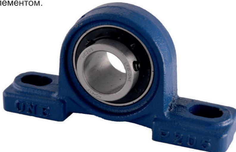
Вертикальный подшипник с уплотненным радиальным шарикоподшипником. Плотная посадка вала обеспечивается с помощью стопорных винтов.
