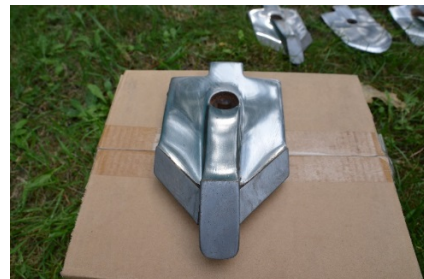
Nach 255ha war der erste Verschleiß deutlich zu erkennen. Die Spitze war bereits rund geschliffen und es entstanden erste Auswaschungen auf der Oberfläche. Der Gewichtsverlust betrug ca. 420g, was etwa 13,5% der Gesamtmasse entspricht.
