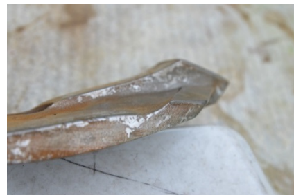
Am Ende der Saison hatten die Schare eine Fläche von ca. 360ha bearbeitet. Während beim „F16“ kaum weitere Auswaschungen zu erkennen waren, war das Standard Schar bis über die Hälfte der Aufpanzerung abgenutzt. Der Materialverlust unseres Schars betrug ca. 510g, was etwa 16,3% seiner Gesamtmasse entspricht. Das Standardschar hatte bis dato ca. 950g verloren, was etwa 43% entspricht. Ein weiterer Einsatz der Standardschare war nicht ratsam, da hier bereits eine starke Rissbildung zu erkennen war.
