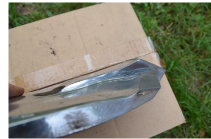
Nach 255ha war der erste Verschleiß deutlich zu erkennen. Die Spitze war bereits rund geschliffen und es entstanden erste Auswaschungen auf der Oberfläche. Der Gewichtsverlust betrug ca. 420g, was etwa 13,5% der Gesamtmasse entspricht.
