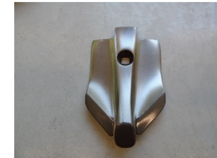
In der Saison 2017 haben wir das Schar weiter arbeiten lassen, bis wir den heutigen Zustand erreicht haben. Es wäre durch aus in der Lage noch mehr Flächenleistung zu erbringen, aber der mögliche Verlust des Schares hätte eine Auswertung unmöglich gemacht. So haben wir das Schar als Studien- und Ansichtsobjekt und können ggf. weitere Erkenntnisse gewinnen.
