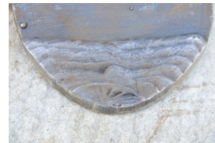
Am Ende der Saison hatten die Schare eine Fläche von ca. 360ha bearbeitet. Während beim „F16“ kaum weitere Auswaschungen zu erkennen waren, war das Standard Schar bis über die Hälfte der Aufpanzerung abgenutzt. Der Materialverlust unseres Schars betrug ca. 510g, was etwa 16,3% seiner Gesamtmasse entspricht. Das Standardschar hatte bis dato ca. 950g verloren, was etwa 43% entspricht. Ein weiterer Einsatz der Standardschare war nicht ratsam, da hier bereits eine starke Rissbildung zu erkennen war.
