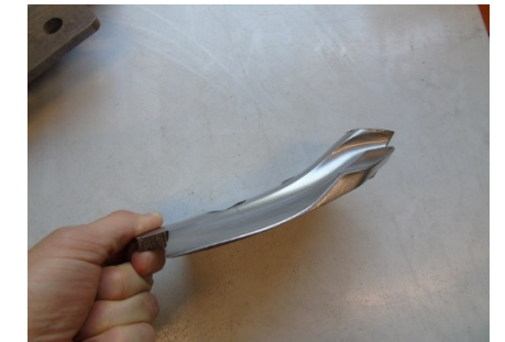
In der Saison 2017 haben wir das Schar weiter arbeiten lassen, bis wir den heutigen Zustand erreicht haben. Es wäre durch aus in der Lage noch mehr Flächenleistung zu erbringen, aber der mögliche Verlust des Schares hätte eine Auswertung unmöglich gemacht. So haben wir das Schar als Studien- und Ansichtsobjekt und können ggf. weitere Erkenntnisse gewinnen.
